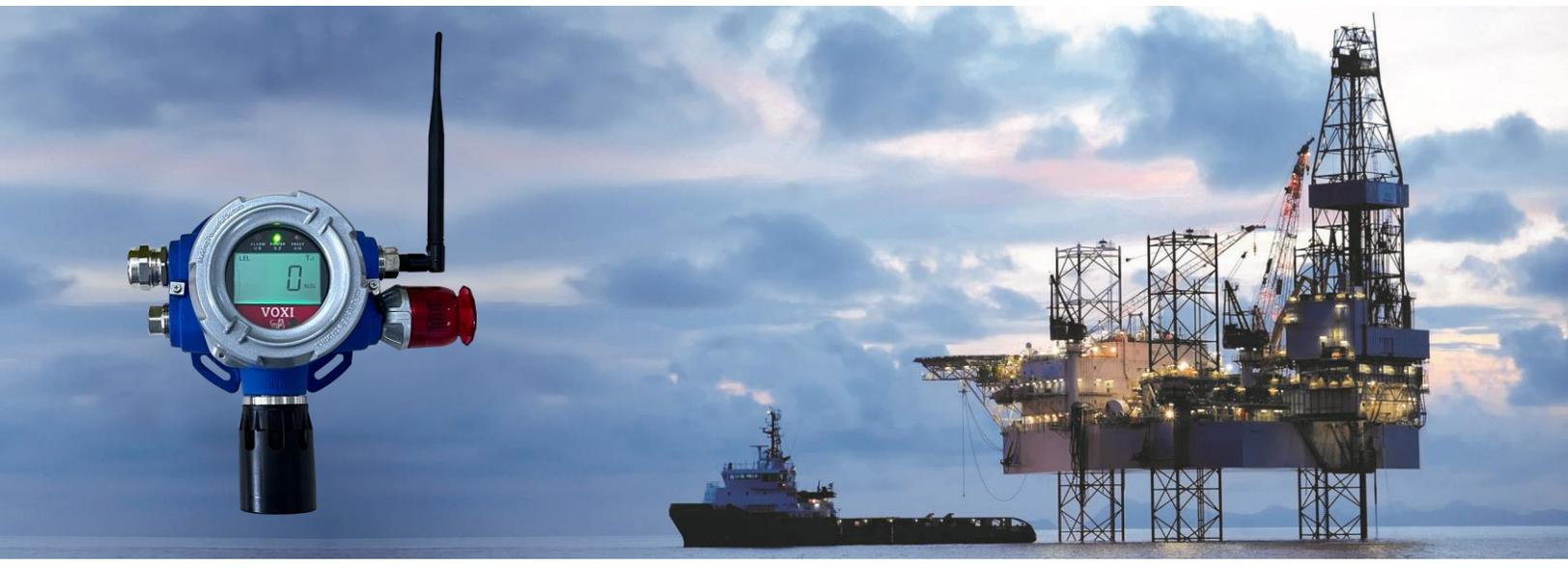
GTYQ-MP820 是一款采用模块化设计的隔爆型固定式点型可燃气体探测器，采用智能化传感器检测技术，可以在恶劣环境中实时检测爆炸下限以内的可燃气体浓度，快速、高效的保护工作人员及安装现场的安全。其智能化处理平台和 Smart 传感器技术，实现了传感器互换、离线标定和零点自校准功能。具有 4~20mA 模拟和 RS485 数字信号输出，可选配无线信号等多种数据传输方式，支持 Hart 协议；三组可编程开关量输出模块，支持输出信号微调等功能，方便系统组网及维护，可根据用户需求定制产品。
