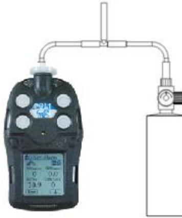
当使用 T 形标定连接管进行泵吸式标定时，确保标准气体的出口压力大于 100 psi（只适合泵吸式）
