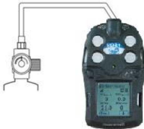
泵吸式的需要一个T形标定连接管，如下示意图。
