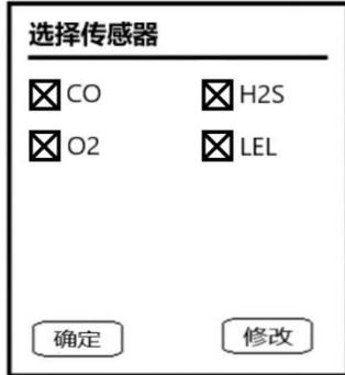
注:如果零点标定已经开始，您可以按下[⏻/↓]键取消多传感器零点标定。
