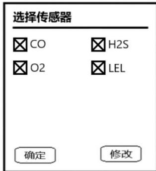
选定的传感器和气体浓度数值显示在屏幕上。校正气体连接到仪器，按[+/OK]键启动多传感器校正气体标定。如果您不想进行多传感器校正气体标定，按下[⏻/↓]键。
