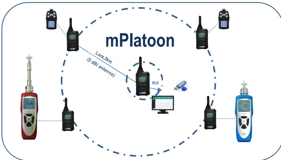
通过内置在 MP400 系列/MP18x 的 LoRa 无线模块和 mLink (MP290x) 进行实时无线通讯, MP29X 之间通讯距离达到 3000 米, mLink 和手机端通过蓝牙通讯。PC 端可以通过公网使用 (mPower Suite RT2.0) 获取相应的数据信息以及位置信息, 并可以用 U 盘进行下载备份。
